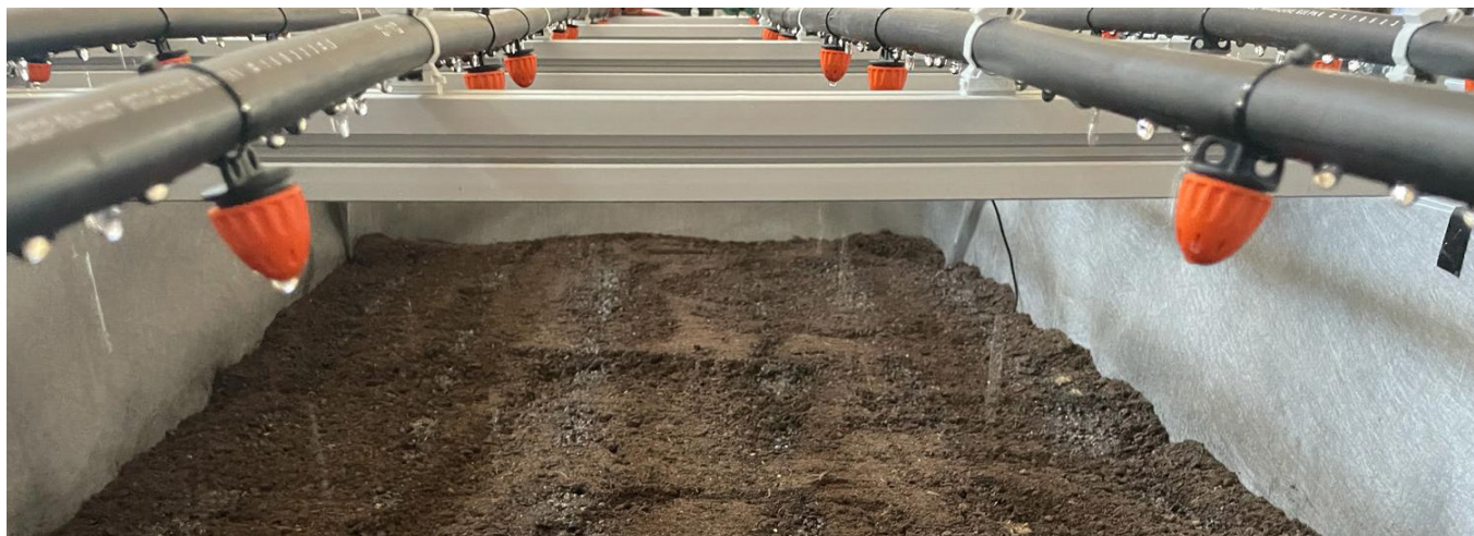
Camera della pioggia presso il laboratorio Ricerca e Sviluppo di Harpo
