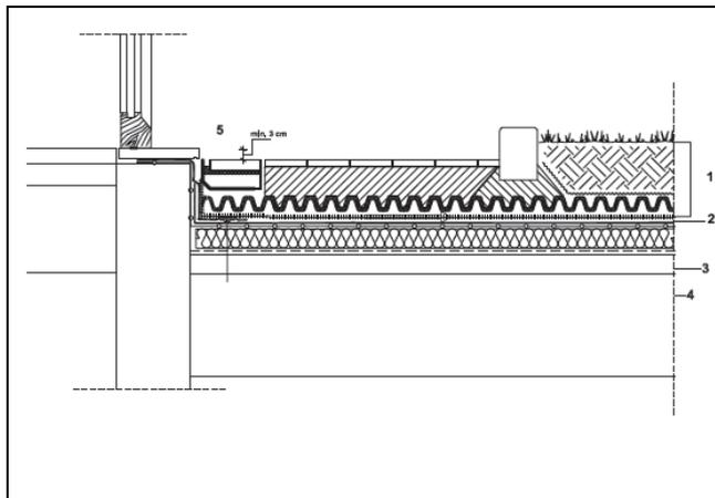
1. sistema verde pensile UNI 11235: TerraMediterranea, elemento filtrante MediFilter MF1, drenaggio accumulo e aerazione MediDrain MD, ritenzione e protezione MediPro
