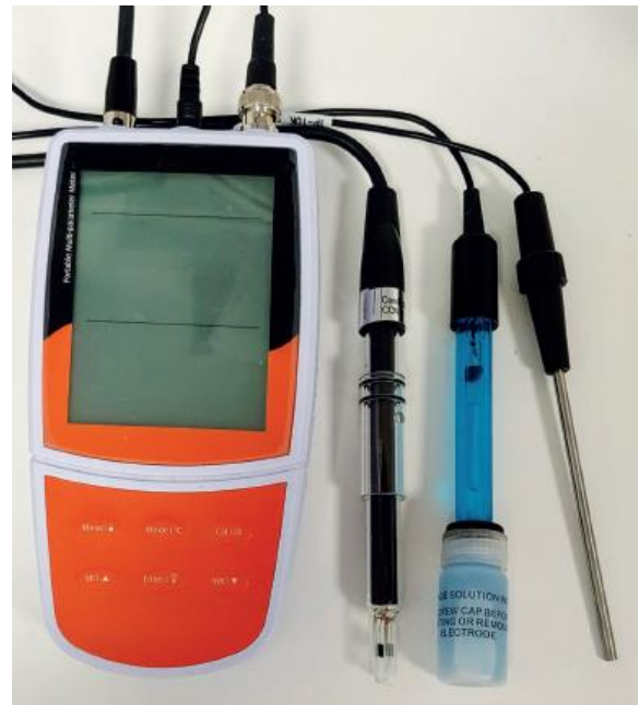
Multimetro ed elettrodi per misure di pH e conduttività elettrica
