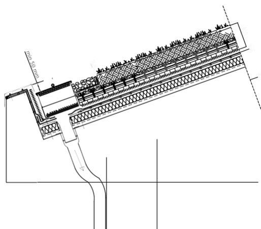
Dettaglio tipo del contenimento a monte di tetti estensivi inclinati.
