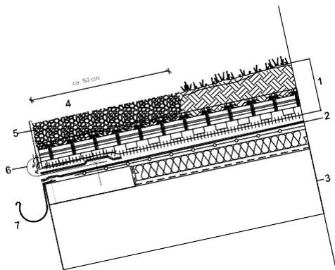
Dettaglio tipo del contenimento a valle di tetti estensivi inclinati. Esempio con muretto di contenimento.
